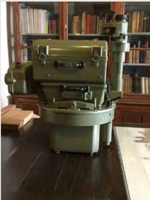
Fotocamera WILD RC8, in gebruik in het NGI tussen 1962 en 1985, Nationaal Geografisch Instituut
